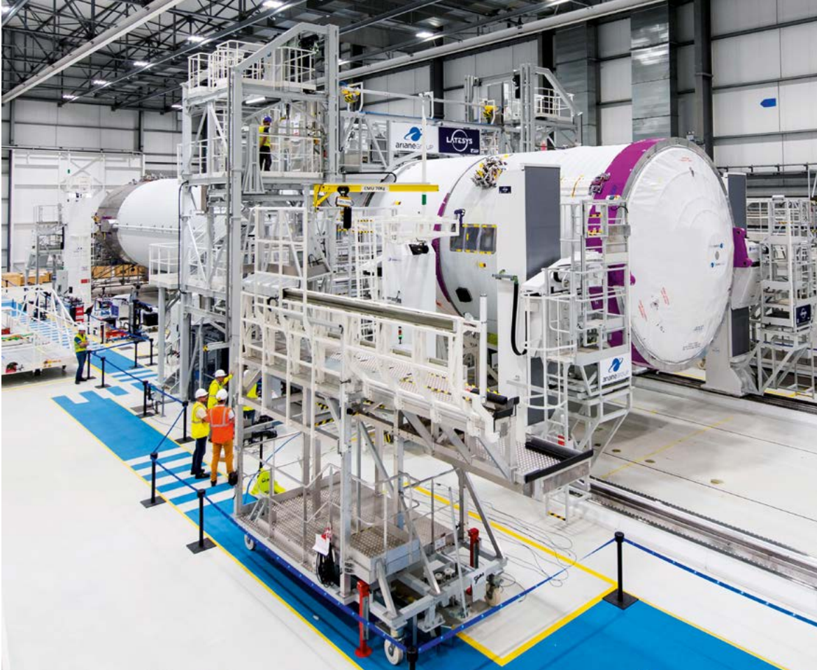
L'assemblage du corps central d'Ariane 6 se fait à l'horizontale, contrairement à l'assemblage d'Ariane 5.
